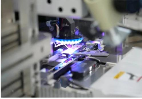
在武汉江夏庙山光电子信息产业园内，武汉安湃光电有限公司(下称“安湃光电”)的洁净车间里，一片片采用新型薄膜铌酸锂材料的晶圆正在被加工成全球领先的高速光调制芯片。这些看似普通的芯片，能实现单波110GHz的调制速率，支撑起3.2T光模块的传输能力——这一数值已达到当前全球商用最高速1.6T模块的2倍。
