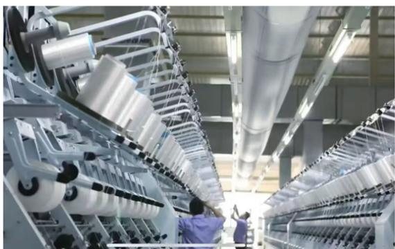
纺织，原是用来织布缝衣。但如今，纺织能让电子屏幕更柔软，让汽车轮胎更扎实。近日，记者在武汉纺织大学看到一台由师生和企业共同研发的加捻机，高大的外壳下，十多卷细丝整齐排列，随着电锭飞速旋转，这些近乎隐形的极细玻璃纤维、高强聚酯工业丝上下翻飞，瞬间“搓”成“科技纱”，被赋予负千斤重的“神力”，汽车轮胎、飞机外壳、柔性屏、电路板都离不开它。
